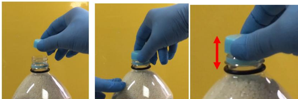
キャップ付ける キャップを緩めてネジの部分で上下カタカタできる状態にする
